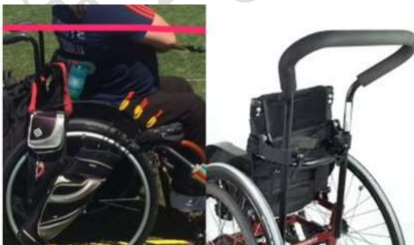
図 29 : 車椅子の背面部分に直接取り付けられていない手押しハンドル
