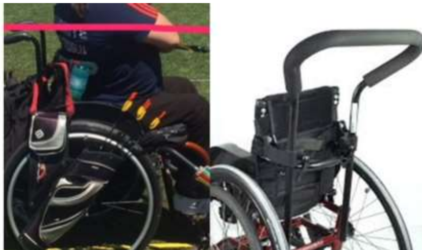
図 29 : 車椅子の背面部分に直接取り付けられていない手押しハンドル
