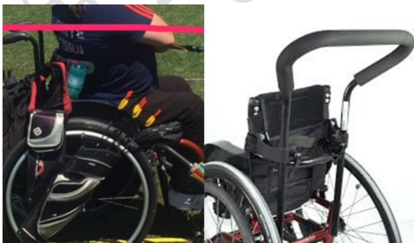
図 31 : 車椅子の背面部分に直接取り付けられていない手押しハンドル
